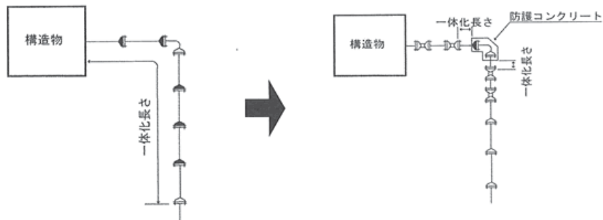
図3 構造物近傍の曲管部に防護コンクリートを設置した例
