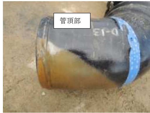
写真4 挿し口（ロックリングとの接触痕なし）
