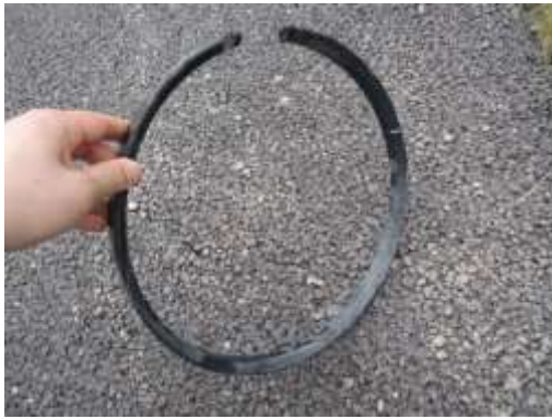
写真3 ロックリング（挿し口との接触痕なし）
