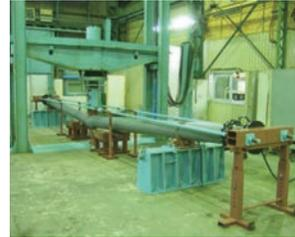
● 図表3-3-2-4 曲げ水密性試験方法(テストバンドによる)
