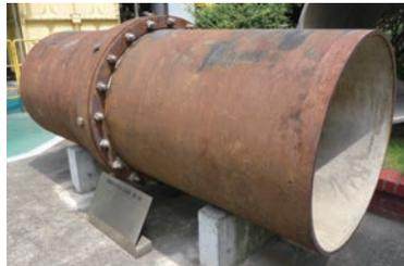
20 八戸市水道部(現八戸圏域水道企業団)が1974(昭和49)年に全国に先駆けて採用した世界初となる耐震継手管。
