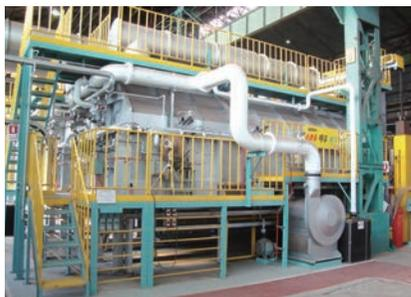
●図表1-4-2-9 バッチ式炉(立型式)
