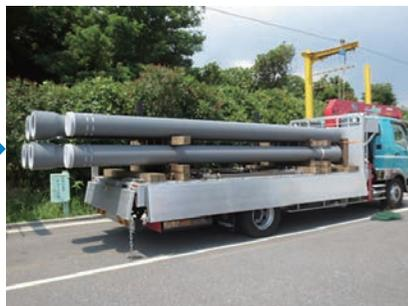
また、現場での荷降ろしや配管作業では、鉄管の吊上げ・吊下ろしに三又さんまたが使われていたが、近年ではクレーンを用いている。特に小口径の工事では積載形トラッククレーンなどが用いられている。
