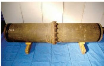
注1 国内最初の遠心力鑄造法によるもの(呼び径700)。
