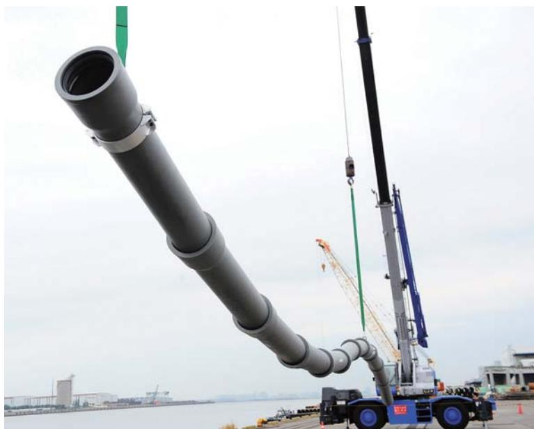
21 大きな地盤変位にも追従できる耐震継手管路
