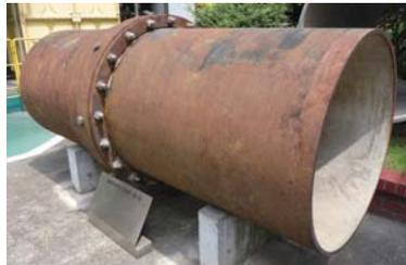
20 八戸市水道部(現八戸圏域水道企業団)が1974(昭和49)年に全国に先駆けて採用した世界初となる耐震継手管。
