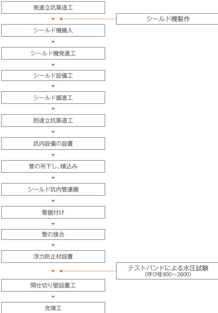
●図表6-3-9-1 シールド内配管の施工手順
