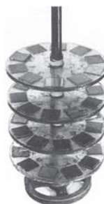
試験片取付け状況
