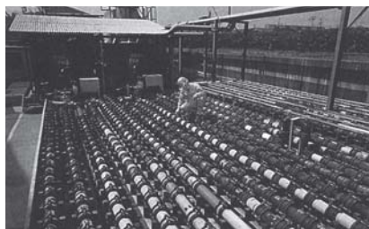
手前がpH2、奥がpH4の通水管路
