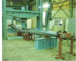
●図表3-3-2-4 曲げ水密性試験方法(テストバンドによる)
