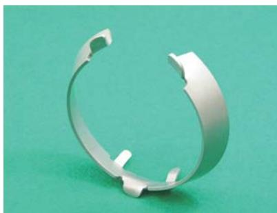
異形管は抜け止め押輪を使用する。地震などにより継手に離脱力が働いた場合は、抜け止め押輪の爪が挿し口外面に食い込み、直管と同じく3DkNの離脱防止性を発揮する。
