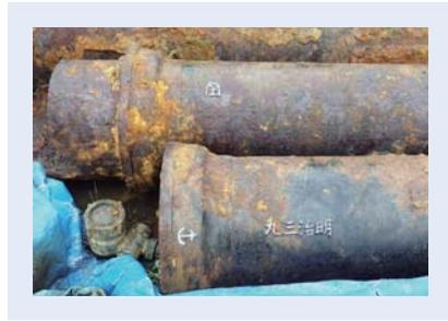
山の田浄水場内の急速ろ過池から第1配水池までの管路として使用していた。
