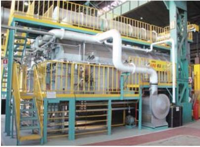
●図表1-4-2-9 バッチ式炉(立型式)
