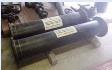
布引ダム五本松堰堤の取水管として使用していた。
