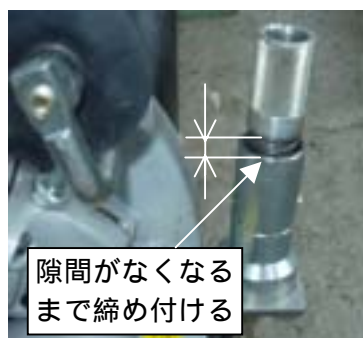
図9 工具押さえ調整ハンドルの締め付け
