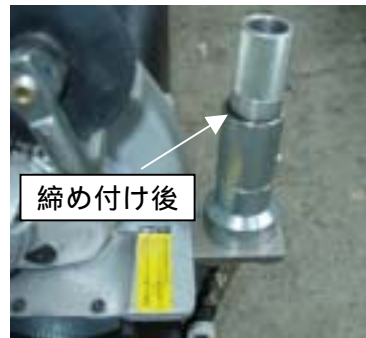
図9 工具押さえ調整ハンドルの締め付け
