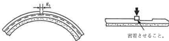
図20 ロックリングの事前確認
