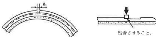
図4 ロックリングの事前確認
