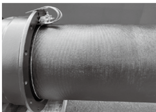
図33 挿し口の挿入状況
