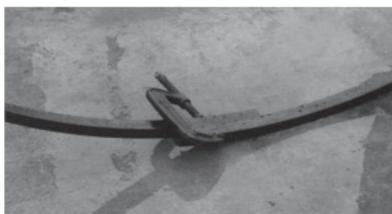
写真2 ロックリング分割部の重ね合わせ
