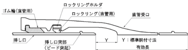
図1 直管の継手構造
