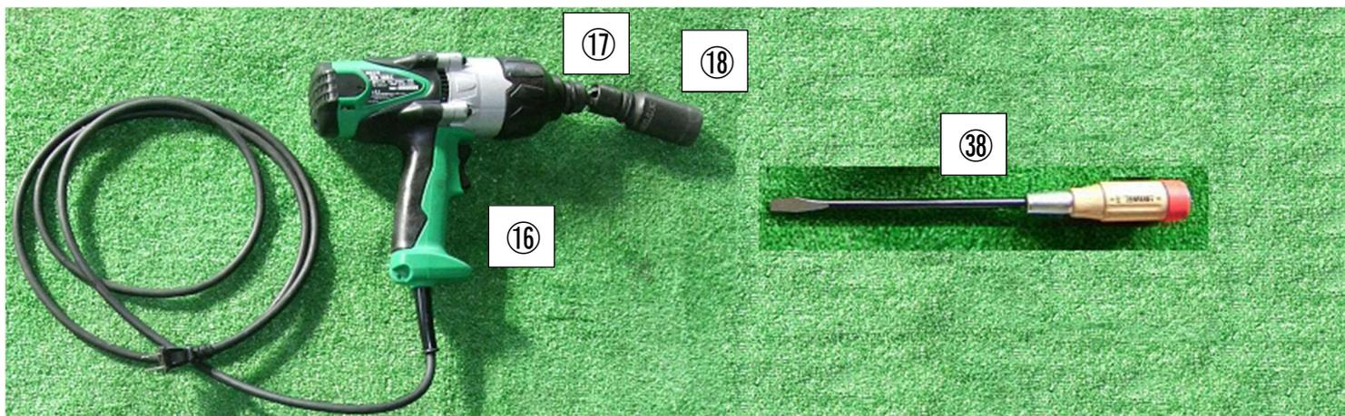
①⑥電動工具(インパクトレンチ) (異形管接合と同じ)
