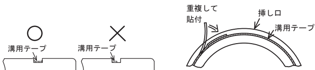
図76 溝用テープ貼り付け方法
