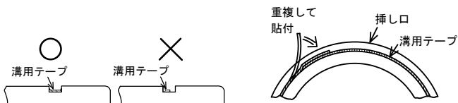
図76 溝用テープ貼り付け方法
