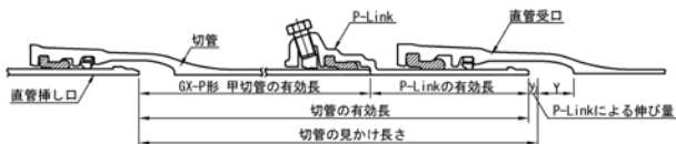
図54 P-Linkを用いた切管有効長
