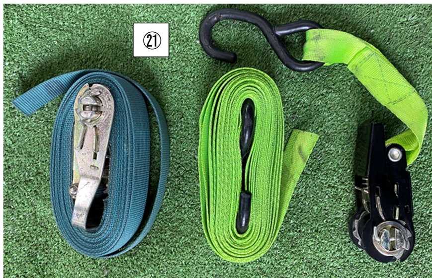
②1 荷締機 (継ぎ輪のせめ配管時に使用。写真の右側、左側どちらでも OK)
