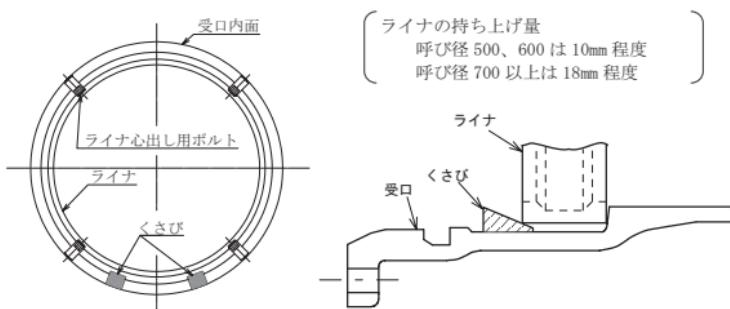
図 37 くさびを使用したライナの仮置き（参考）
