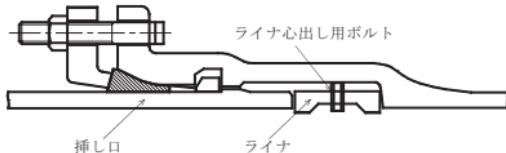
図 2 ライナを使用した直管の継手構造
