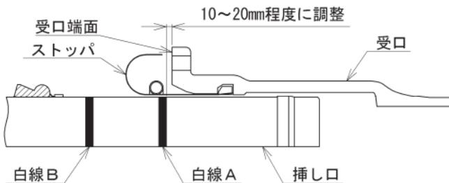
図 11 挿し口の挿入
