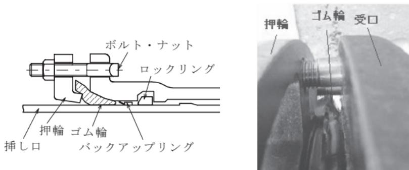
図24 ゴム輪の乗り上げ（接合不良）
