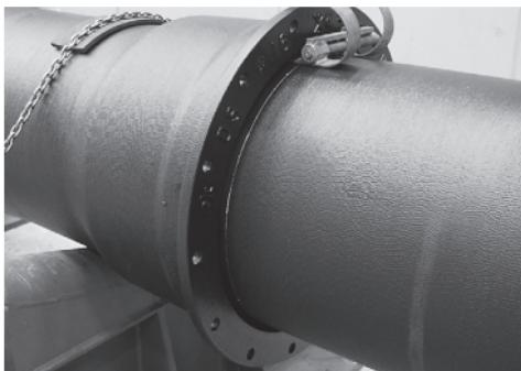
図 33 挿し口の挿入状況
