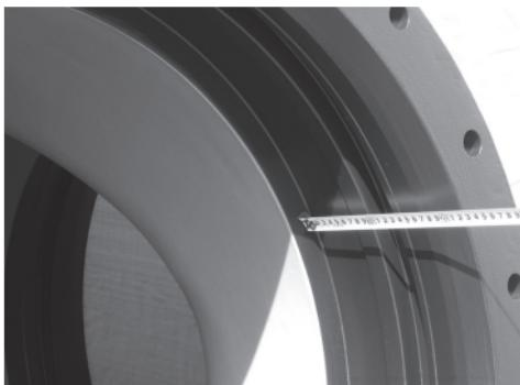
図 27 挿し口挿入量の測定
