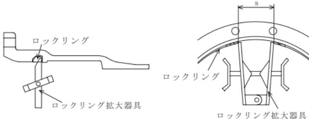
図6 ロックリング拡大器具の装着
