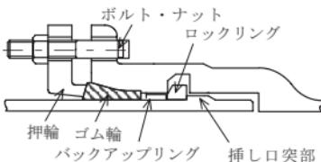
図3 異形管の継手構造
