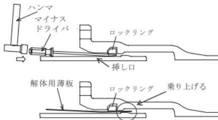
図 57 解体用薄板の挿入
