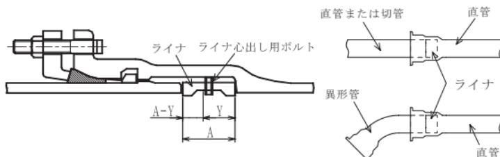
図34 ライナ使用時の継手構造
