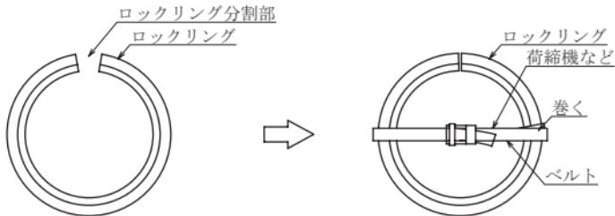
図44 ロックリングの絞り方法（せめ配管の場合）
