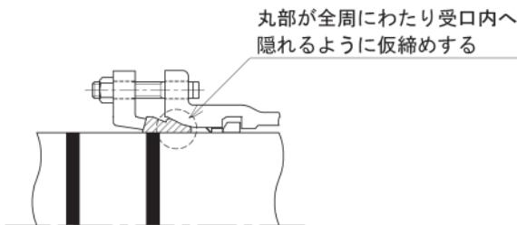
図 18 仮締めとゴム輪の押し込み
