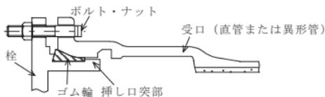
図45 栓の継手構造
