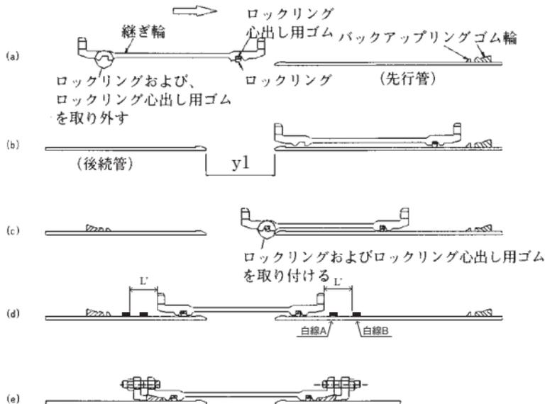
図50 継ぎ輪の施工手順(せめ配管の場合)
