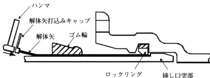
図92 解体矢の打込み(異形管)
