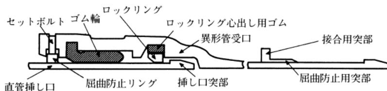
図3 異形管の継手構造(呼び径75~250)
