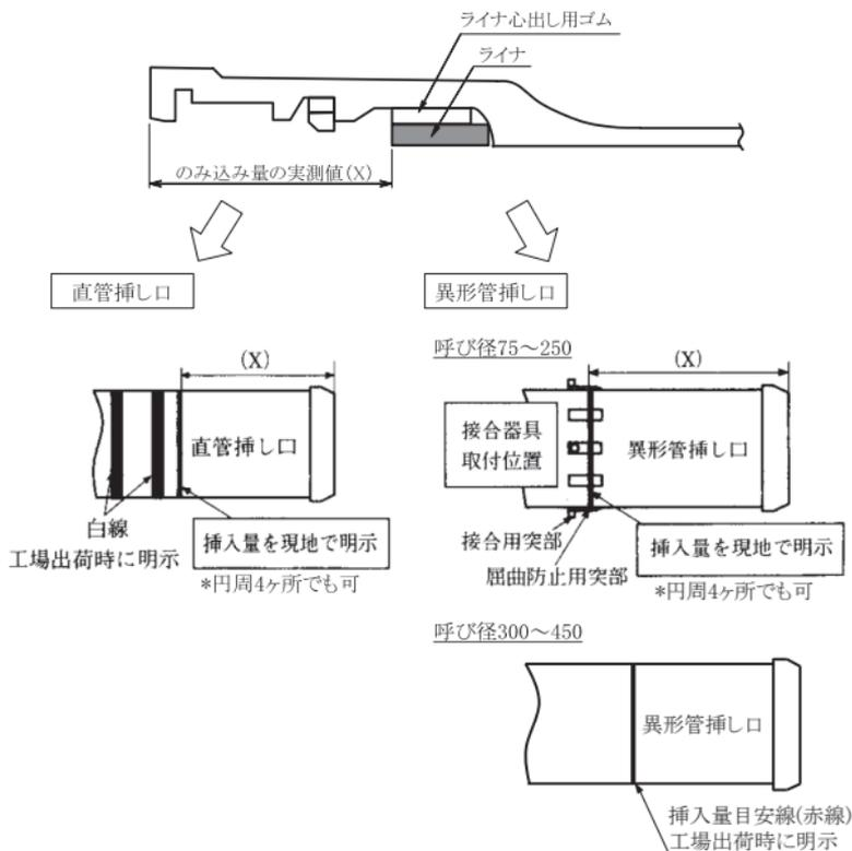
図44 挿し口挿入量の明示
