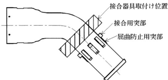
図24 接合器具取り付け位置
