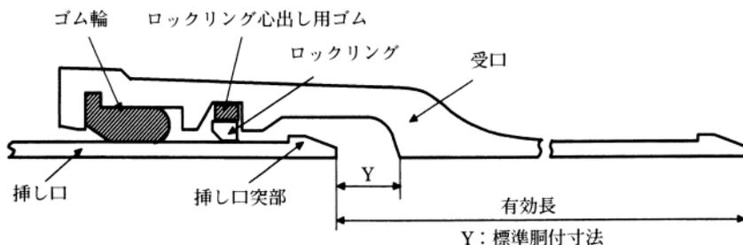
図1 直管の継手構造
