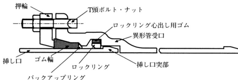
図4 異形管の継手構造(呼び径300~450)
