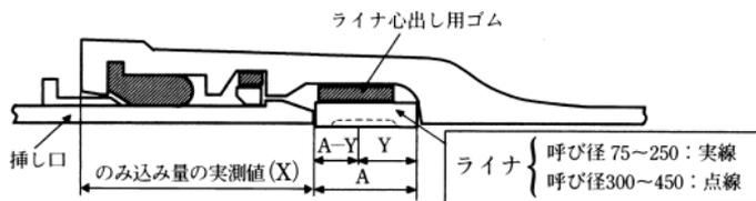
図41 ライナ使用時の接合構造
