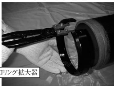
図61 切管用挿し口リングのセット
