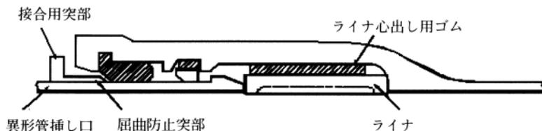
図2 直管の継手構造(ライナ使用)
