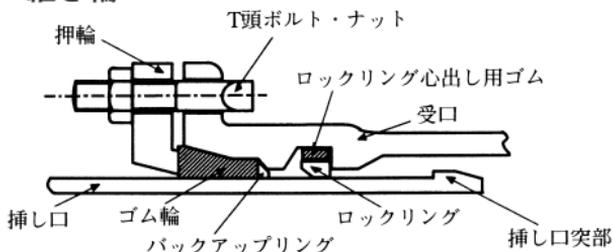
図5 継ぎ輪の継手構造
