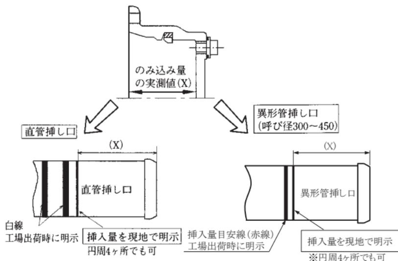
図52 挿し口挿入量の明示
