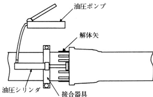
図91 接合器具を解体に使用する場合
