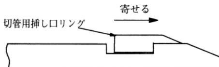
図77 切管用挿し口リングのセット
