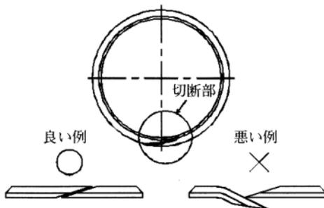
図37 バックアップリングの切断部
