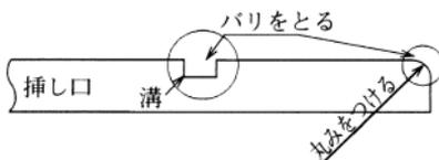
図68 挿し口のバリ取り、および面取り
