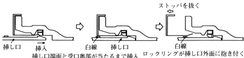
図35 挿し口の挿入
