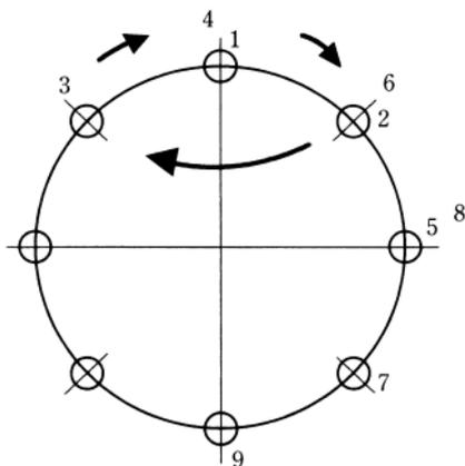
標準締め付けトルク (ボルトねじの呼びM20) · · · 100 N · m
