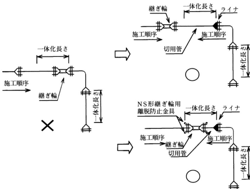
図51 異形管周りでの継ぎ輪の設置方法
