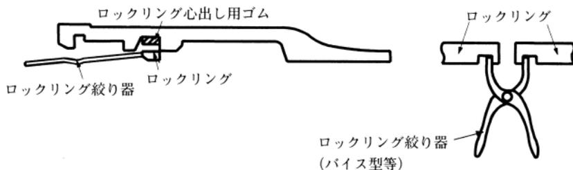
図8 ロックリングの取り外し
