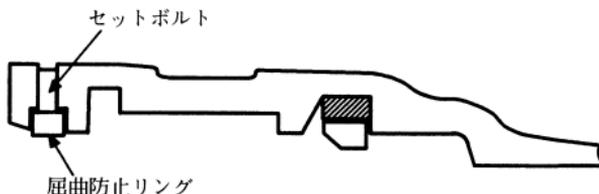
図22 異形管のセットボルトおよび屈曲防止リング
