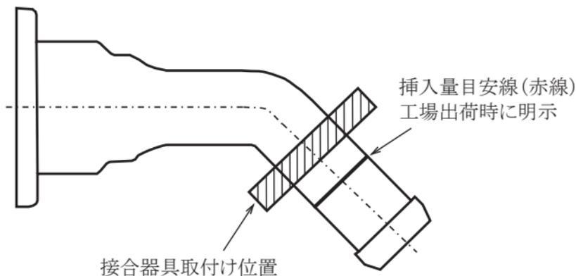
図46 接合器具取付け位置(呼び径300~450異形管)
