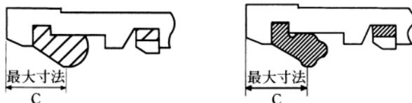
図13 ゴム輪位置の最大寸法(c)の測定
