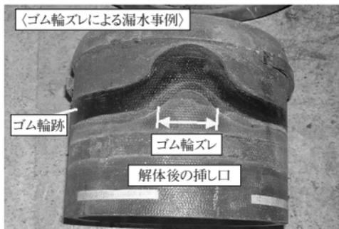
図20 ゴム輪ズレによる漏水事例
