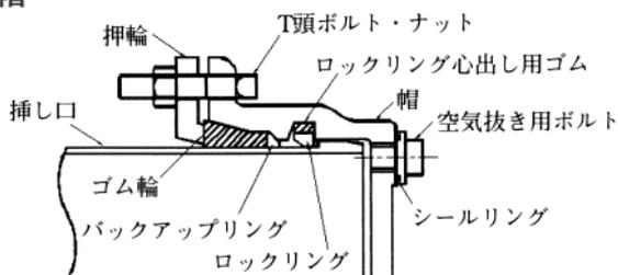
図6 帽の継手構造
