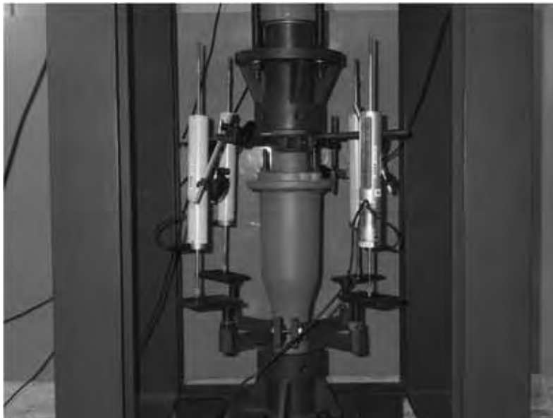
写真6 離脱防止性能試験状況
