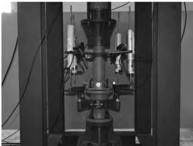
写真 7 離脱防止性能試験状況(異形管)
