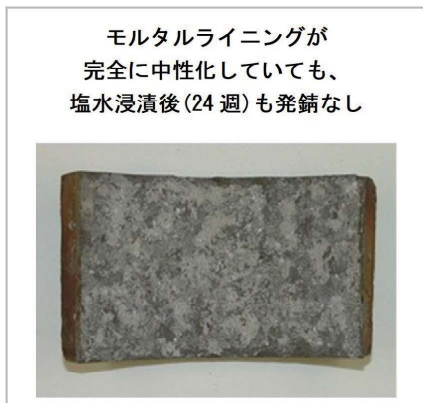
図21 中性化深さの測定結果
