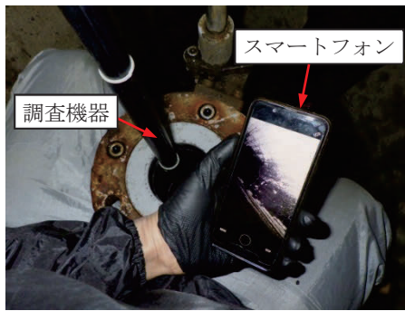
写真5 デジタルカメラ調査状況(空気弁室での調査)
