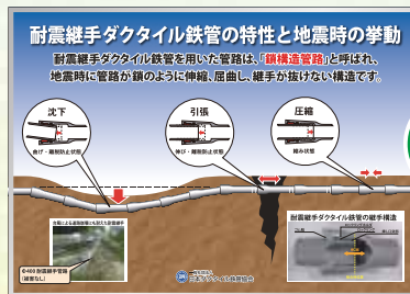
耐震継手ダクタイト鉄管の 特性と地震時の挙動
