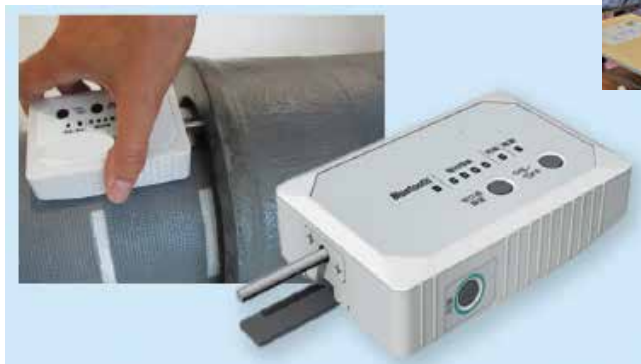
写真6 ゴム輪位置を測定する機器
