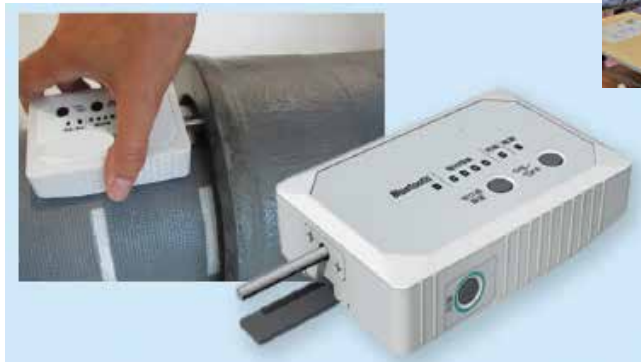
写真6 ゴム輪位置を測定する機器
