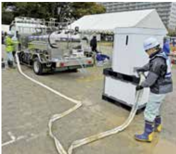
給水車と応急給水タンク
