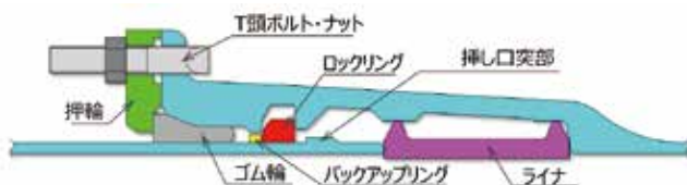
図 4 ライナ付き直管の継手構造 (GX 形)
