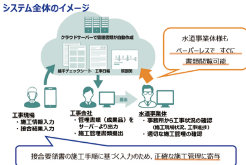
図 10 施工管理システムの全体イメージ
