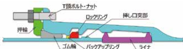
図 4 ライナ付き直管の継手構造 (GX 形)
