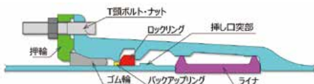
図 4 ライナ付き直管の継手構造 (GX 形)
