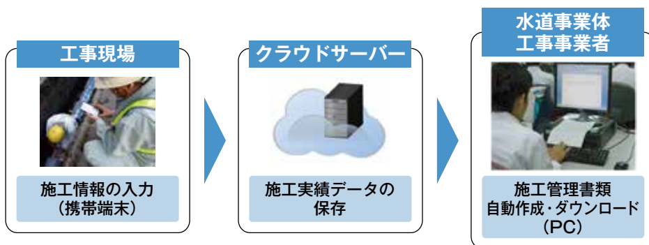
図1 施工管理システムの構成概要
