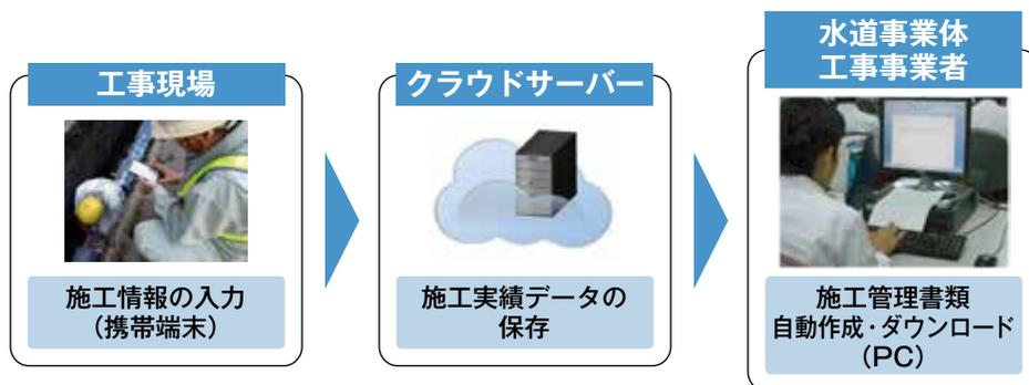
図1 施工管理システムの構成概要
