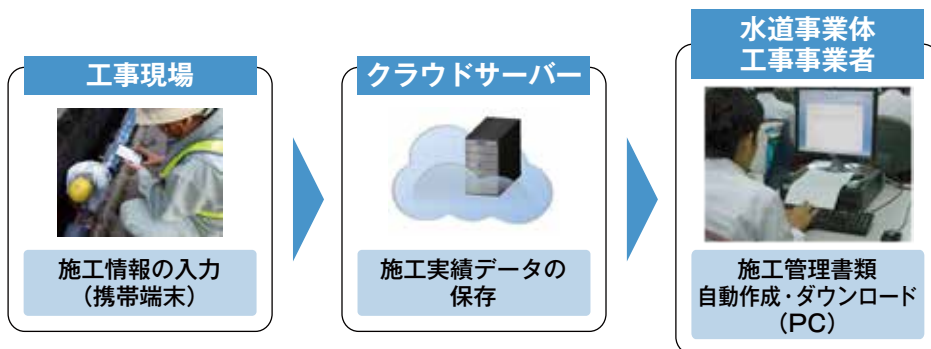
図1 施工管理システムの構成概要
