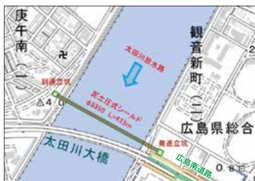
図 2 太田川放水路横断所
