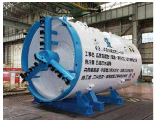
写真 1 シールドマシン
