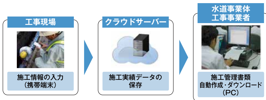
図1 施工管理システムの構成概要
