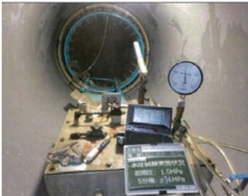
写真4 テストバンド水圧試験状況(PN形)
