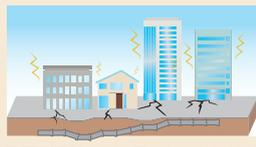
耐震継手は伸縮・屈曲し、管路が地盤変動に追従し、地震などの災害に強い管路を構築します。
