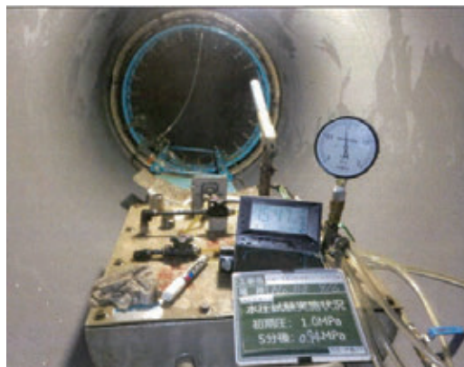
写真4 テストバンド水压試験状況(PN形)
