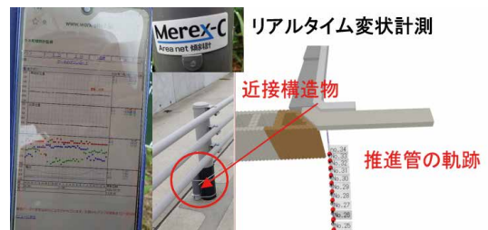
図7 距離確認と変位計測
