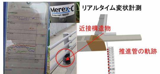
図7 距離確認と変位計測
