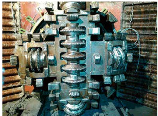
写真4 到達時のカッターヘッド
