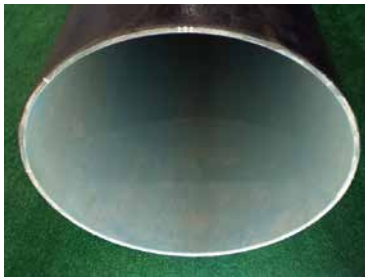
異常なし 写真8 内面状況
