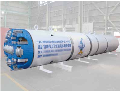
写真1 シールドマシン全景
