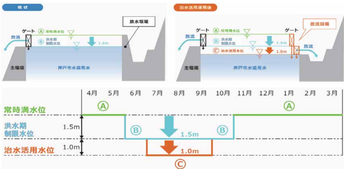
図4 千苜ダム 治水活用概要図
