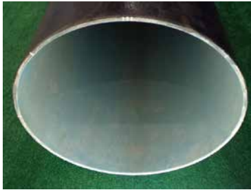
異常なし 写真8 内面状況
