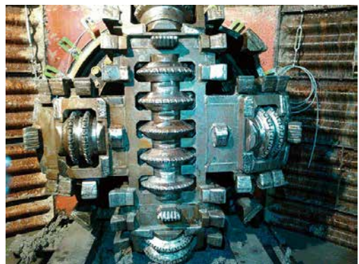
写真4 到達時のカッターヘッド
