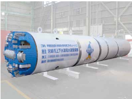
写真1 シールドマシン全景
