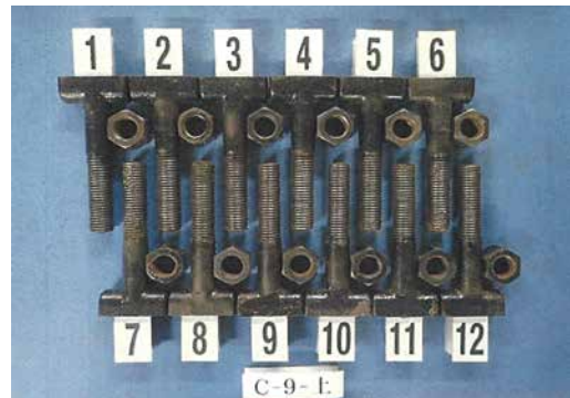
写真12 ナイロン被覆 DCI 製ボルトナット
