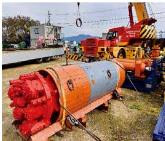
写真2 共同管推進用掘進機 (エースモール DL70N)
