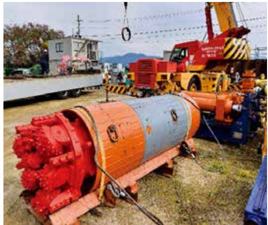
写真2 共同管推進用掘進機 (エースモール DL70N)
