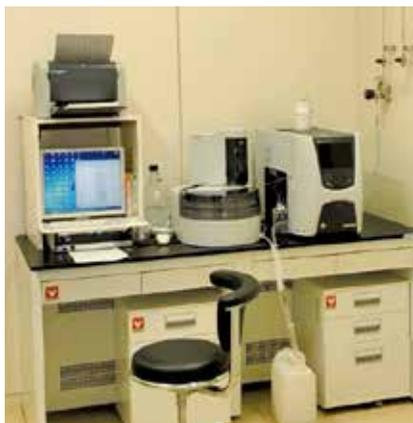
水中の有機物の量を測定します(全有機炭素計)
