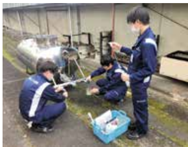
給水タンクにおける残留塩素濃度の測定実験
