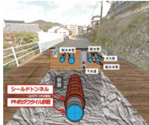
図1 工事区間断面のイメージ
