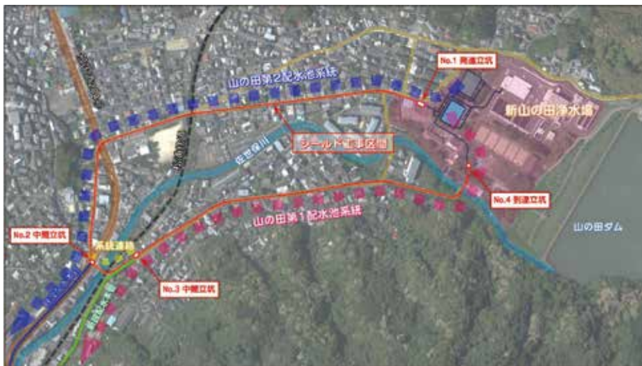
図2 シールド線形平面図
