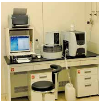
水中の有機物の量を測定します(全有機炭素計)
