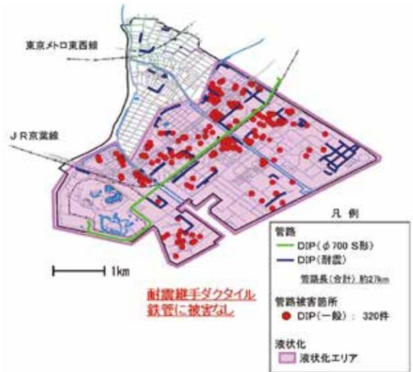
図2 液状化による管路被害集中箇所でも被害がなかった耐震継手ダクタイトイル鉄管
