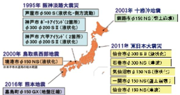
図9 耐震管路の挙動調査実績 7)~14)
