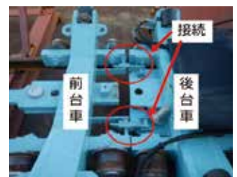
写真4 運搬台車接続状況
