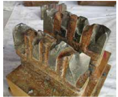
写真5 摩耗したビット (山岳工区)
