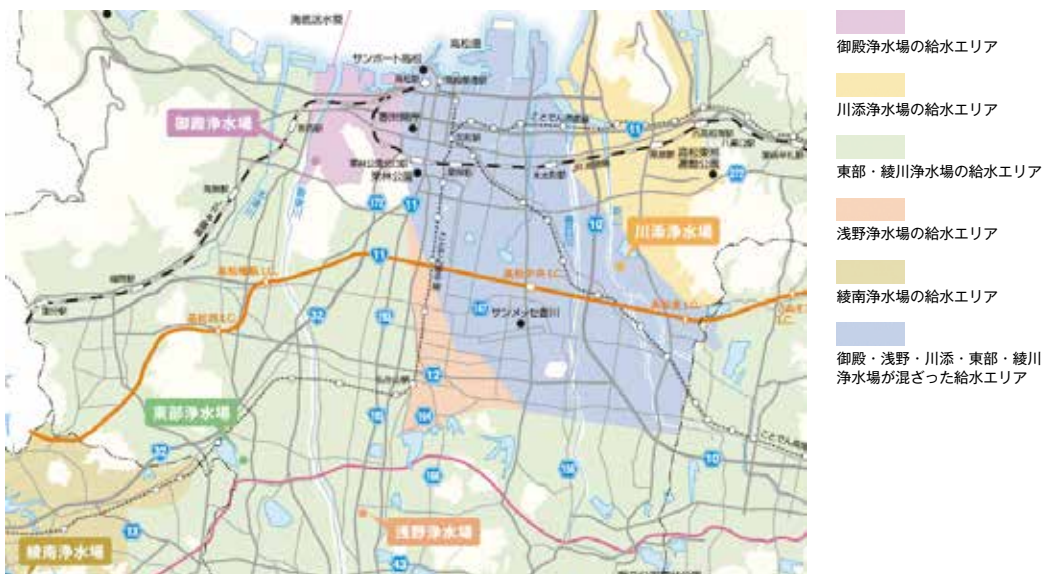
図1 高松ブロック給水エリア(中心部)
