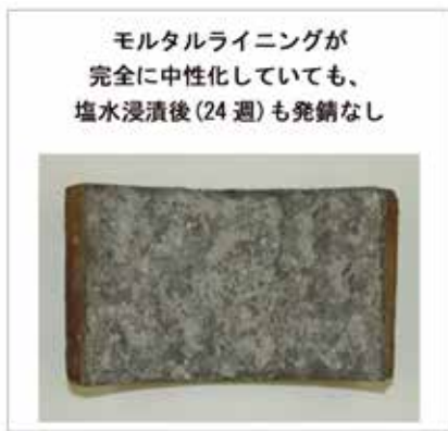
図 21 中性化深さの測定結果
